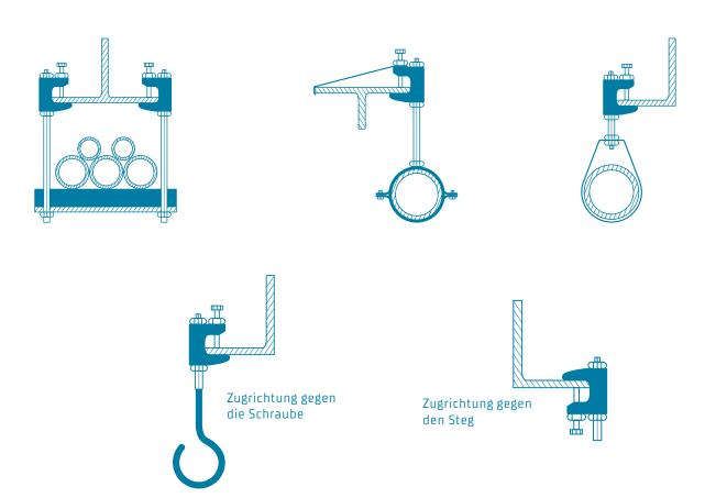
Unsere Trägerklammern vom Typ TK und TKN können sowohl in Zugrichtung gegen die Feststellschraube als auch in Zugrichtung gegen den Steg montiert werden. Weitere Informationen entnehmen Sie bitte unserer Montageanleitung.
