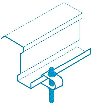
**Der Pfettenclip ermöglicht die Abhängung an Z-förmigen Pfetten.**
