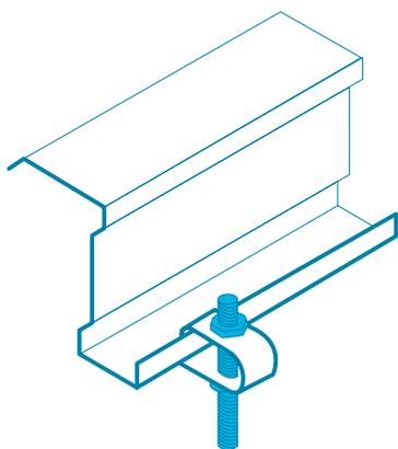
La fixation sur panne permet la suspension à des pannes en forme de Z.
