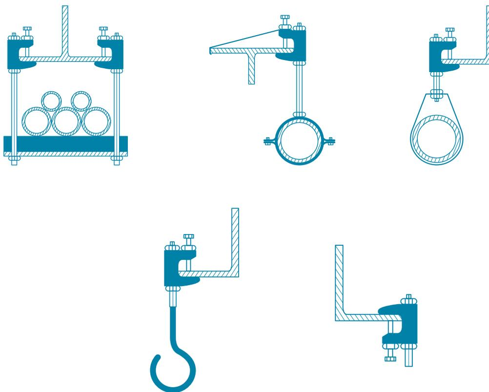
Nuestras abrazaderas para soporte del tipo TK y TKN se pueden montar tanto en la dirección de tracción contra el tornillo de fijación como en la dirección de tracción contra el muelle. En las instrucciones de montaje encontrará información más detallada al respecto.
