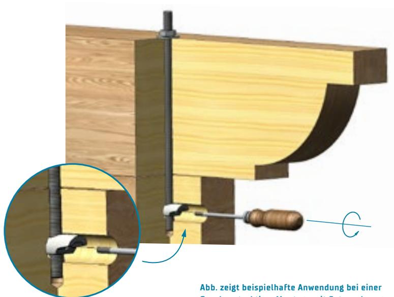
Abb. zeigt beispielhafte Anwendung bei einer Querverkonstruktion, Montage mit Setzwerkzeug.
