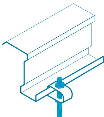
Le clip panne "Z" permet la suspension à des pannes en forme de Z.
