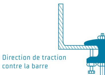
Nos attaches pour poutres de type TK et TKN peuvent être montées autant direction de traction contre la vis que direction de traction contre la barre. Vous trouverez de plus amples informations dans nos instructions de montage.
