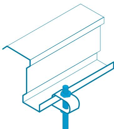
**Der Pfettenclip ermöglicht die Abhängung an Z-förmigen Pfetten.**
