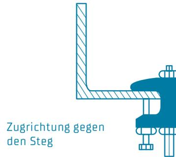
Unsere Trägerklammern vom Typ TK und TKN können sowohl in Zugrichtung gegen die Feststellschraube als auch in Zugrichtung gegen den Steg montiert werden. Weitere Informationen entnehmen Sie bitte unserer Montageanleitung.
